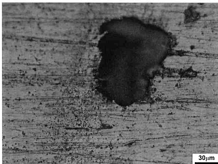
Figura 17. Aspecto da superfície do aço 298 após ensaio de polarização. Nota-se a presença de pite. Aumento 500x. Microscópio óptico
