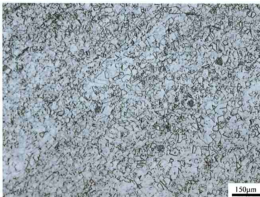
Figura 7. Micrografia do aço 298 resultante da prática A. Face da chapa. Aumento: 100x. Microscópio óptico
